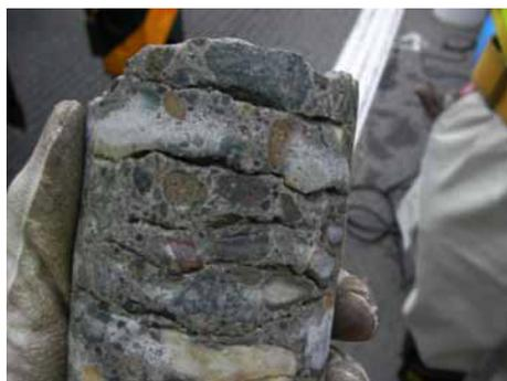
床版に生じた多数の水平ひび割れをコンクリートコアでも確認できる
