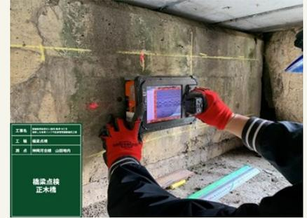
点検調査状況（鉄筋探査）
